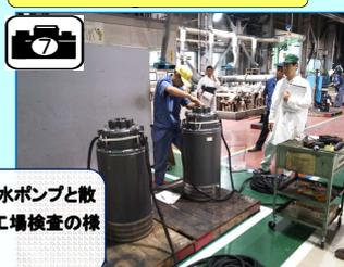
消雪用の取水ポンプと散水ポンプの工場検査の様子です。
